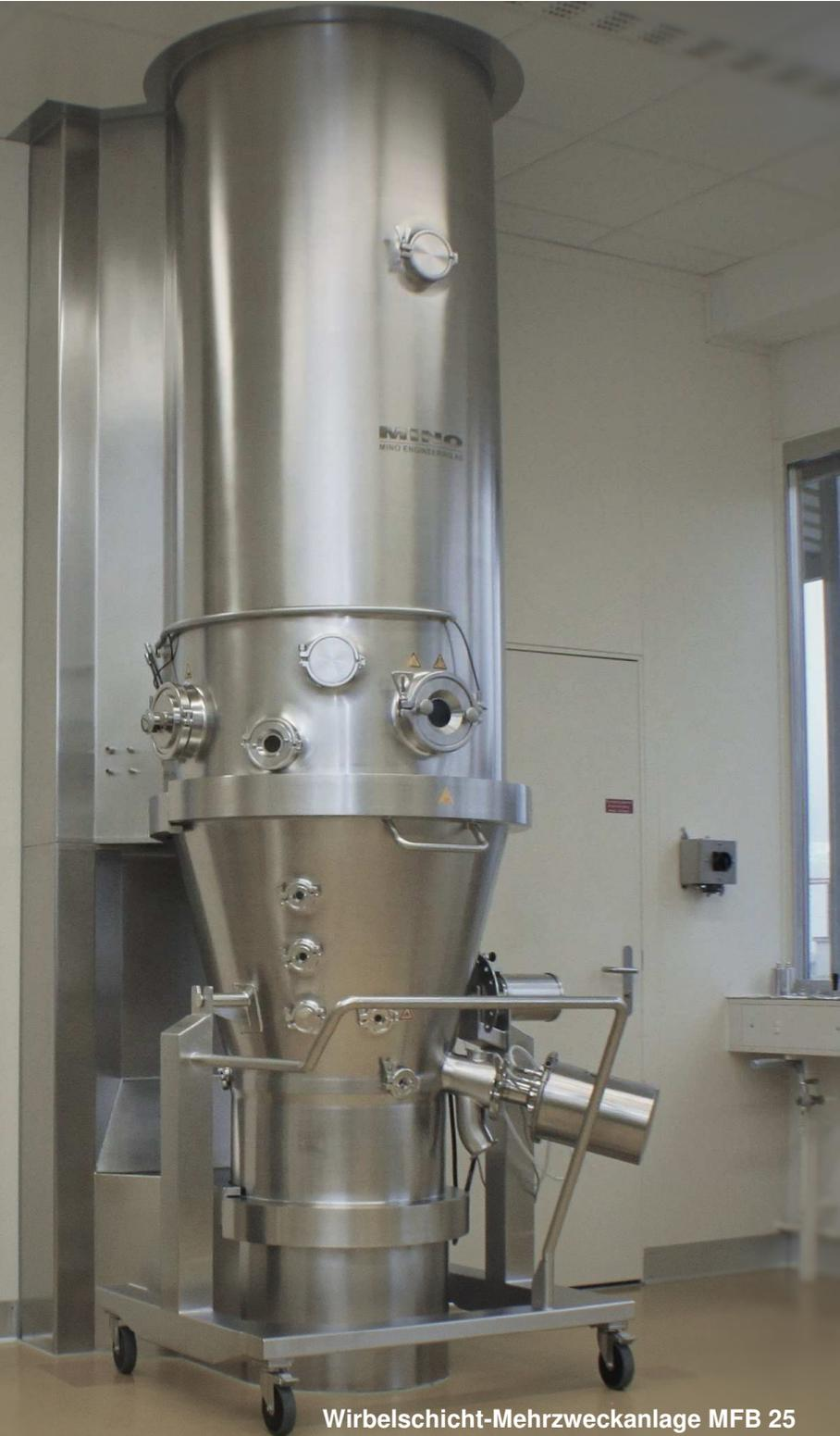
Wirbelschicht-Mehrzweckanlage MFB 25
